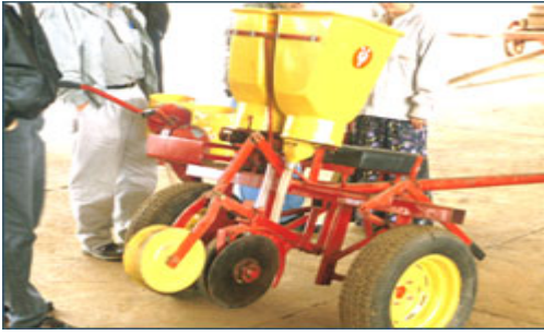
Fig.4 Semoir avec deux coutres, et des pneus avec jantes en fonte
