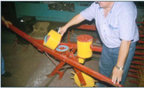
Fig.12 Plateau d'un semoir motorisé standard utilisé dans un
