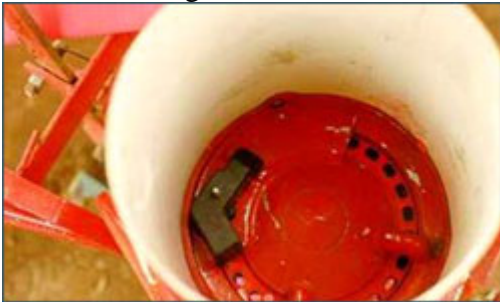
Fig.10 Détail de l'intérieur d'une trémie de semoir de semis
