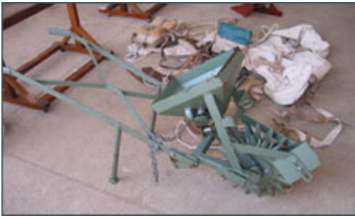
Fig.9 Un semoir monograine avec poinçonneuse rotative.
