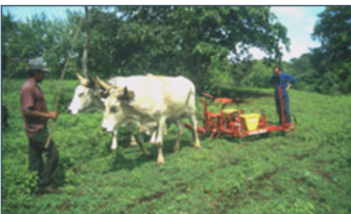
Fig.8 Un semoir à deux rangs avec poinçonneuse rotative.
