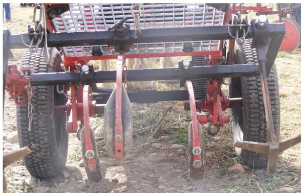
*Cadre équipé de dents flexibles et sous-soleuses à ailettes*
